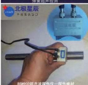
BSN900超声波探伤仪—探伤棒材
