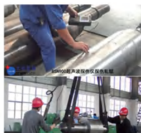
204000超声波探伤仪探伤现场
