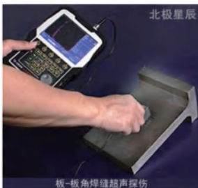
板-板角焊缝超声探伤
